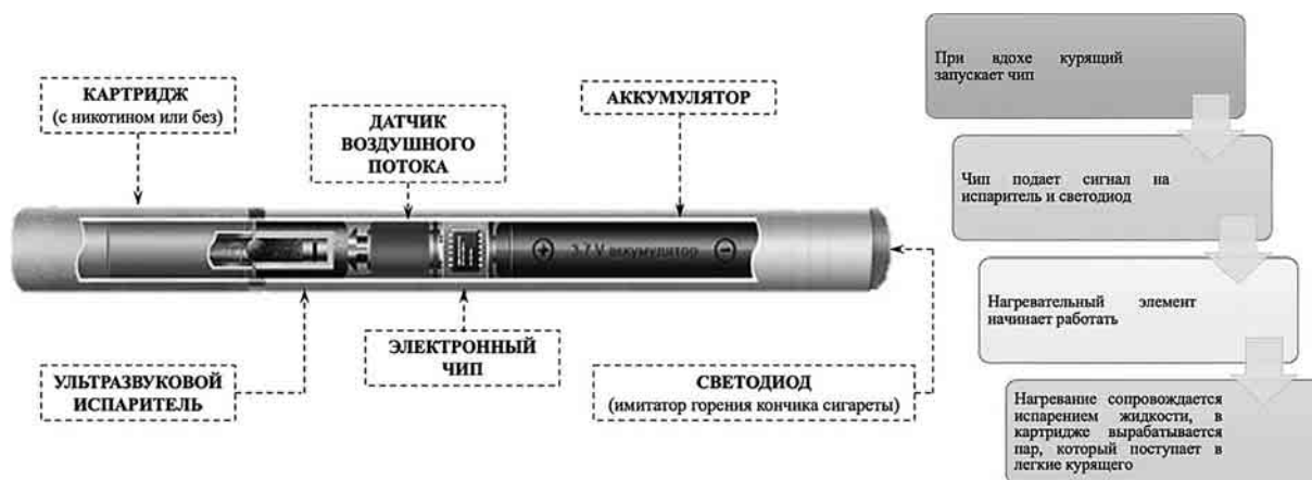
Основные элементы, из которых состоит электронная сигарета, и принцип ее работы.
