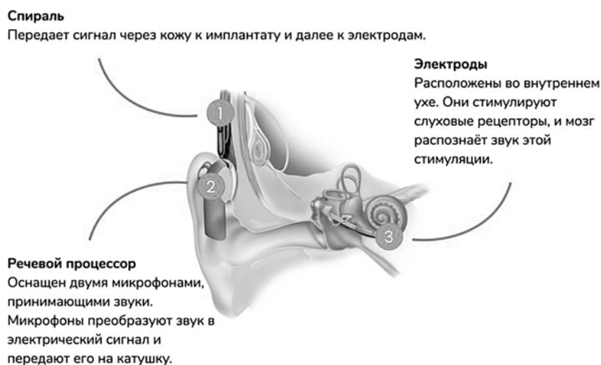
Рис. 1. Принцип работы кохлеарного импланта [9].
