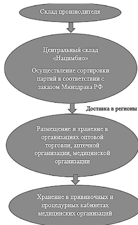
Рис. 3. Схема холодовой цепи для сохранения качества и безопасности замороженных ИЛП на примере вакцины Спутник-V.
